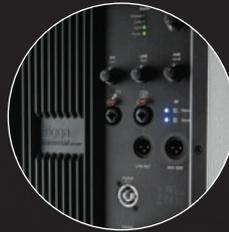
Los controles separados le permiten crear un sonido bien equilibrado, y los LED de estado muestran el estado del amplificador de un vistazo.
